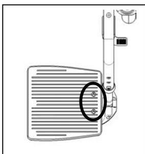
Las bases del apoyapiés se pueden ajustar a diferentes profundidades. Afloje los tornillos de la base del apoyapiés. De esta forma podrá desplazar la placa unos 3 cm hacia atrás o hacia delante. Después de desplazarlas, asegure nuevamente las bases con los tornillos de sujeción.
