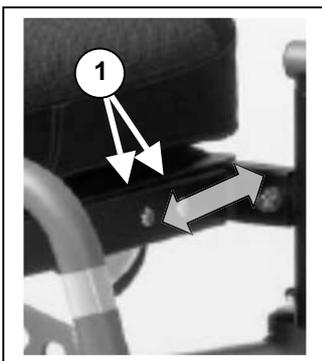
Los soportes del apoyapiernas pueden ajustarse en anchura. Para ello, suelte las uniones atornilladas (1) y lleve el soporte del apoyapiernas a la posición deseada. Apriete nuevamente las uniones atornilladas (1) a mano.
