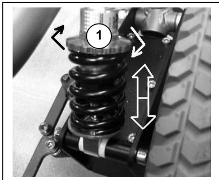
Gire el ajuste (1) hacia la izquierda para alargar el recorrido del muelle y suavizar la amortiguación. Si desplaza el ajuste (1) hacia la derecha se reduce el recorrido del muelle y se endurece la amortiguación.
