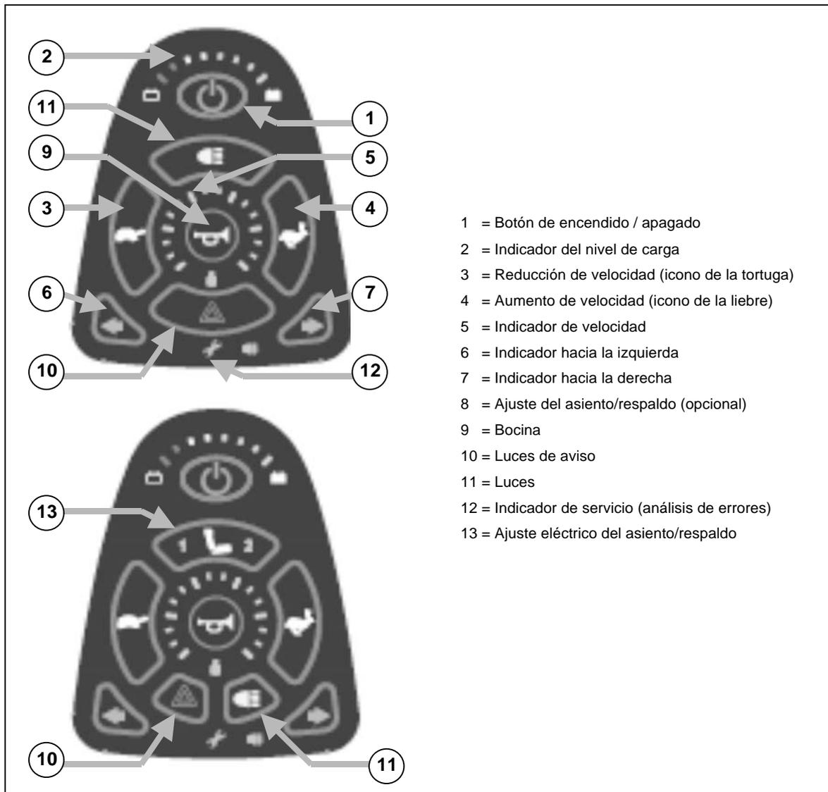
Pulse la tecla de encendido/apagado **(1)**. El indicador de carga **(2)**, que también informa sobre el estado de carga de las baterías, se enciende durante unos segundos. Si se encienden todos los LED, el nivel de carga de las baterías es suficiente. Si no se encienden todos los LED, deberá limitar las operaciones de circulación para que el consumo de las baterías sea mínimo. Si los LED del indicador de carga de las baterías no se encienden, compruebe las conexiones del sistema electrónico.
