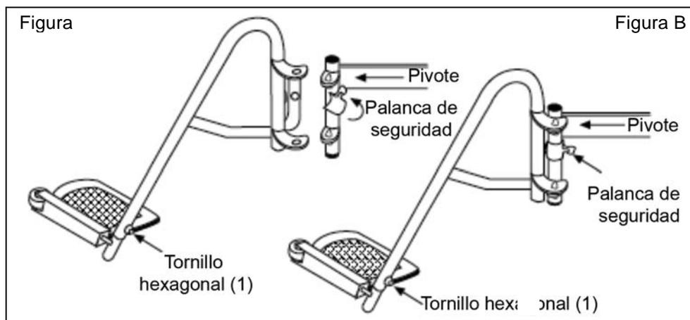
Para posicionar el apoyapiés, cuelgue lateralmente uno de los apoyapiernas hacia fuera en los pivotes y hágalo girar hacia dentro hasta que quede enclavado. Primero, deberá colocar la palanca de seguridad (fig. B) de manera que esté orientada hacia atrás. Si el apoyapiernas no se engatilla de inmediato, presiónelo un poco hacia dentro. Haga lo mismo con el del otro lado. Para extraerlos, siga el mismo procedimiento pero en sentido inverso.
