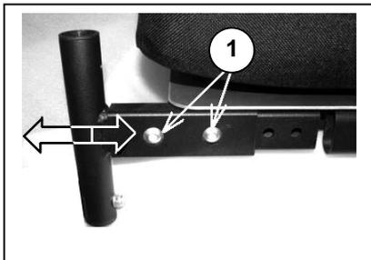
Para ajustar la longitud de muslos del asiento, afloje las uniones atornilladas del lado delantero del bastidor del asiento (1) a ambos lados del bastidor y podrá posicionar el soporte del apoyapiernas en 4 profundidades distintas. Una vez colocado en la posición deseada, vuelva a apretar bien las uniones atornilladas (1).
