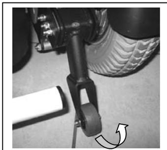
La silla de ruedas eléctrica incorpora una protección antivuelco para garantizar su seguridad, que funciona con un sistema de amortiguación y que, a la hora de superar pequeños obstáculos (con una altura máxima de 70 mm), se inclina ligeramente hacia atrás, sin embargo evita el vuelco mediante un tope. No quite la protección antivuelco, ya que la silla de ruedas dejaría de ser segura contra vuelcos involuntarios.
