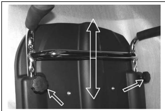
La altura de las asideras deslizables (arco de desplazamiento) puede ajustarse aflojando los tornillos de detención laterales y llevando el arco de desplazamiento hasta la altura deseada. Vuelva a apretar firmemente los tornillos de detención a mano. Tenga en cuenta que los tornillos de detención se detienen en las hendiduras del arco de desplazamiento, para garantizar una sujeción segura.
